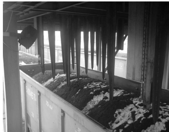
Рис. 3 Вид на рыхлящие штыри перед внедрением в сходящийся угольный агрегат
