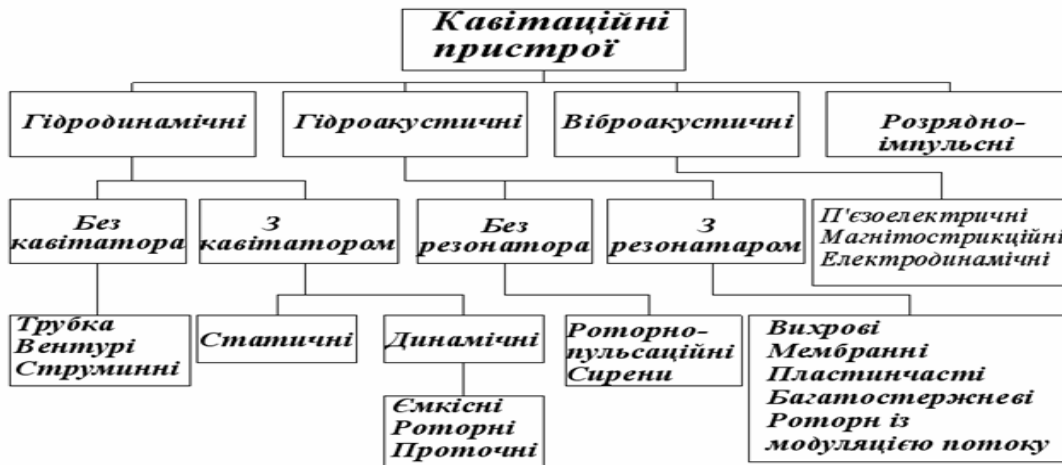
Рис. 1. Основні різновиди структурно-конструктивних схем кавітаційних пристроїв
