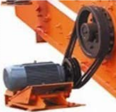
Электродвигатель с клиноременной передачей
