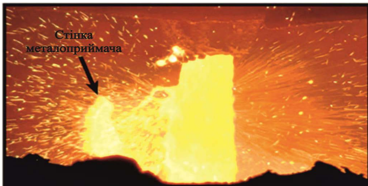
Рис. 10 – Віялоподібна форма струменя при витіканні зі сталерозливного ковша
