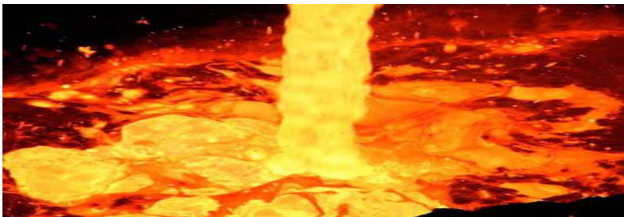
Рис. 1 - Характер турбулентних потоків у зоні падіння струменя зі сталерозливного ковша.
