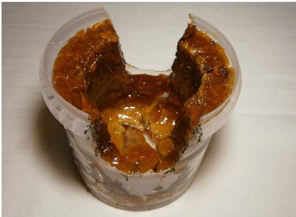
Рис. 16 Стан металопримача після шести годин моделювання.
