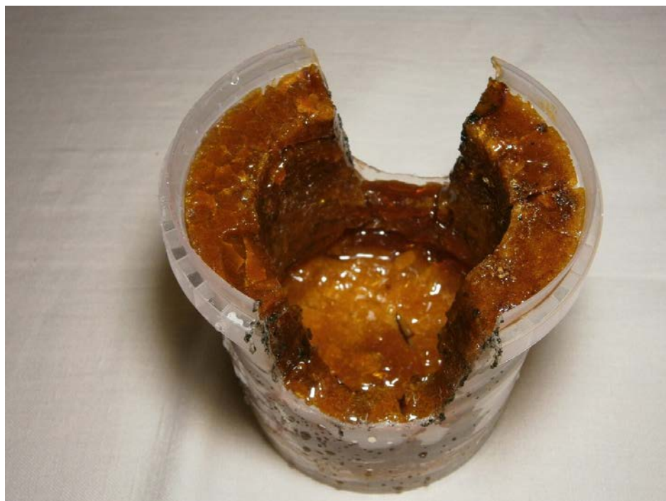
Рис. 14 Стан металопріймача після двох годин моделювання.
