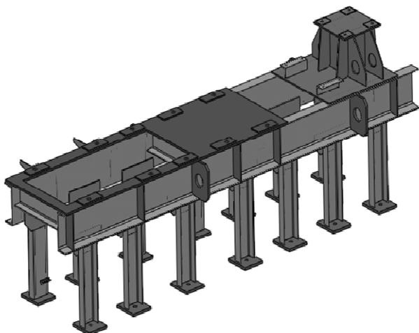
Идея работы заключается в определении рационального количества стоек и такого расположения их по длине, при котором максимально полно будет использоваться жесткость горизонтальных балок рамы с тем, чтобы не превзойти допустимые величины деформаций рамы. Такие деформации должны исключить взаимное смещение и перекосы концов валов двигателя и редуктора, соединяемых муфтой, свыше допустимых норм [1, 2].
