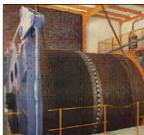
Рис. 3. В отличие от отечественных шахтных подъемных машин, за рубежом часто применяют барабаны без подкреплений
