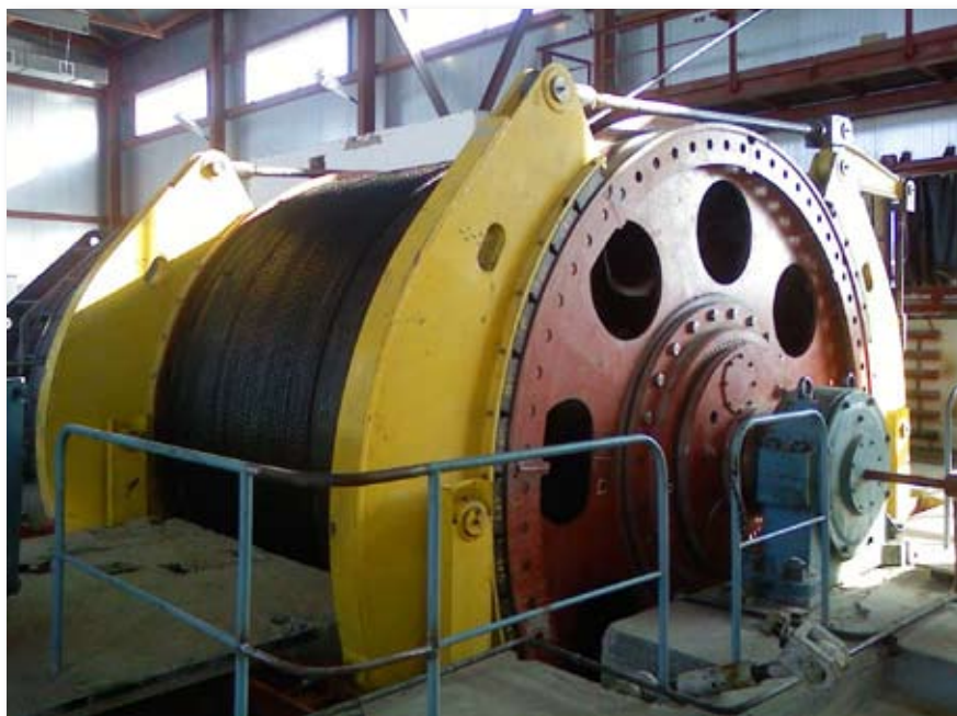
Рис. 14. Шахтные подъемные машины с цилиндрическими барабанами, выпускаемые Новокузнецким машиностроительным заводом
