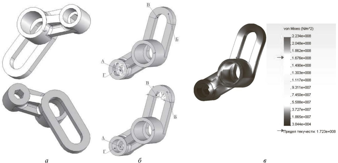
Рис. 15.28. Ескіз аналізованої деталі ( a ), умови закріплення та навантаження деталі ( б ), а також аналіз результатів розрахунків
