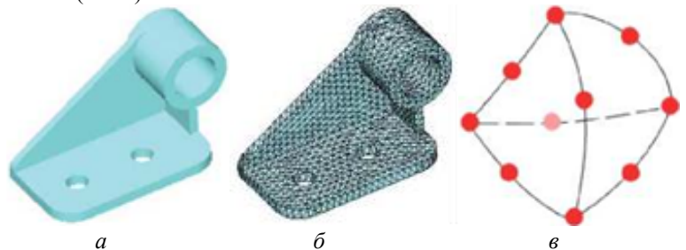
Рис. 15.27. Модель кронштейна (а), модель, поділена на дрібні елементи (б) та тетрадральний елемент (в) (червоні точки позначають вузли елемента, кромки елементів можуть бути вигнутими або прямими)
