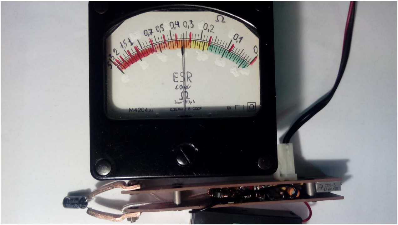
16. Перевірка електролітичного конденсатора, який був у користуванні
