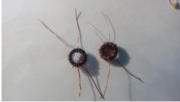
5. Дві катушки - трансформатори
