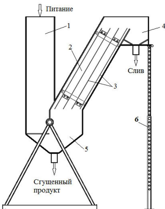
Лабораторная установка (см. рис.) состоит из корпуса 2. Внутри корпуса на расстоянии 38 мм друг от друга под углом 60° к горизонту укреплены пластины 3. Исходную суспензию подают к загрузочному устройству 1, из которого она поступает в промежутки между наклонными пластинами. Осветленная вода переливается в сливной желоб 4 и выводится из установки. Частицы под действием сил тяжести осаждаются на поверхности наклонных пластин, соскальзывают в шламовый бункер 5 и выгружаются из него.
