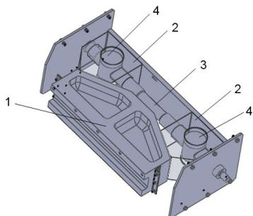
С использованием методов теоретической механики определено расчетное усилие, действующее на ползун – 2,1 МН. В дальнейшем планируется рассчитать напряженно-деформированное состояние деталей методом конечных элементов в пакете SolidWorks Simulation с целью определения запасов прочности конструкции и выявления слабых мест для дальнейшей модернизации.
